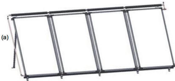
El sistema mínimo para un captador se compone por un kit base más un kit disipador de inicio, para baterías de paneles se necesitarán tantos kits disipador ampliación hasta completar la batería (n-1). Ejemplo batería de 4 PSV 20:
